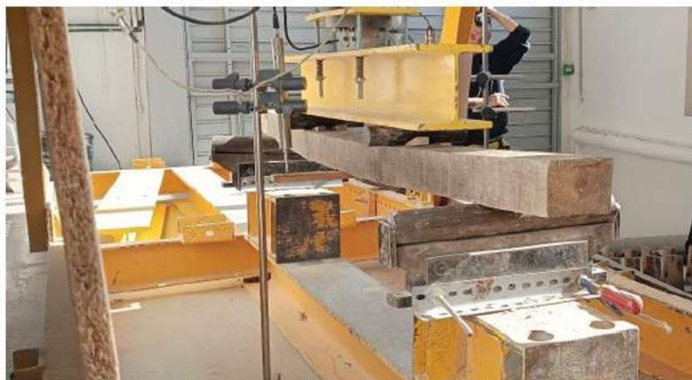
Fotografia 1: Assaig de biga amb càrrega bipuntual a L/3
